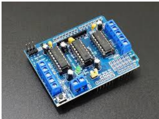
Annexe 10 : Shield moteur pour Arduino pour le pilotage du pousse-plaque
