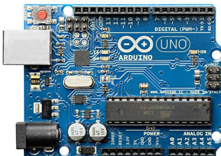
Annexe 11 : Arduino utilisé pour le contrôle des moteurs du pousse-seringue et du pousse-plaque
