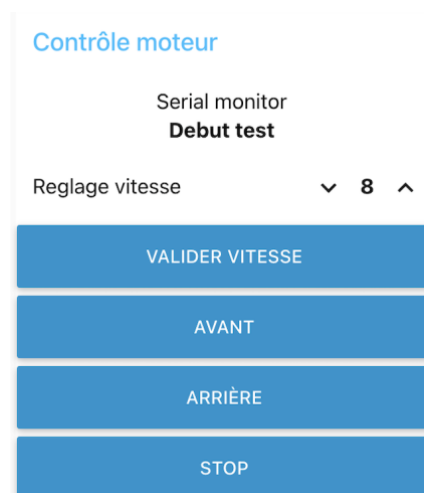
Figure 4 : Dashboard Node-Red pour le contrôle du pousse-seringue
